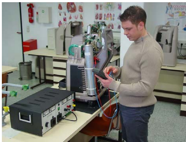
Betrieb eines Sauerstoffkonzentrators am Trenntransformator zur Signalverfolgung und Überprüfung des Spülzyklus
